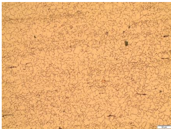
Figura 2. Material torsionado a 4\text{s}^{-1} , 1200°C.
